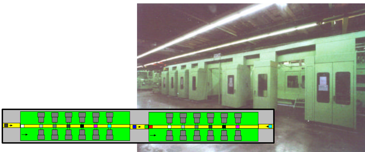
Bild 1: Lineare Transferstraße (Photo und Prinzip)
